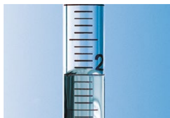
Ménisque convexe dans une pipette graduée.
