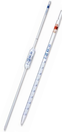
Pipette jaugée et graduée
