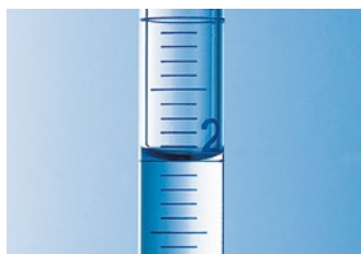
Ménisque concave dans une pipette graduée.
