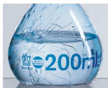
Revestimiento PUR para reducir los peligros del efecto de astillado
