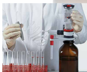
Seriendosierung mit flexiblem Dosierschlauch
